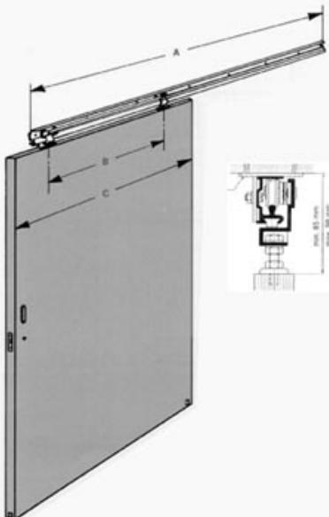
Ferrures pour portes coulissantes silencieuses, profil aluminium anodisé, chariot de galets en akulon sur roulement à billes. Poids maxi de la porte 60 kg
