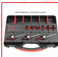
3 adaptateurs universels et élargisseur pour trépan de 14 à 152 mm
