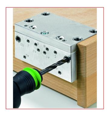
GABARIT DE PERÇAGE BLUEJIG QUADRO EB 20 / QUADRO 4D POUR COULISSES / POICNÉES ET BOUTONS
